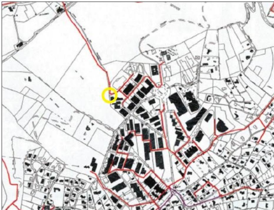
Figure 34 : Réseau d'assainissement des eaux usées
