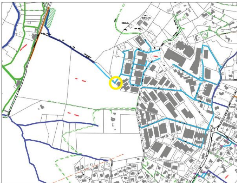
Figure 35 : Réseau d'assainissement des eaux pluviales
