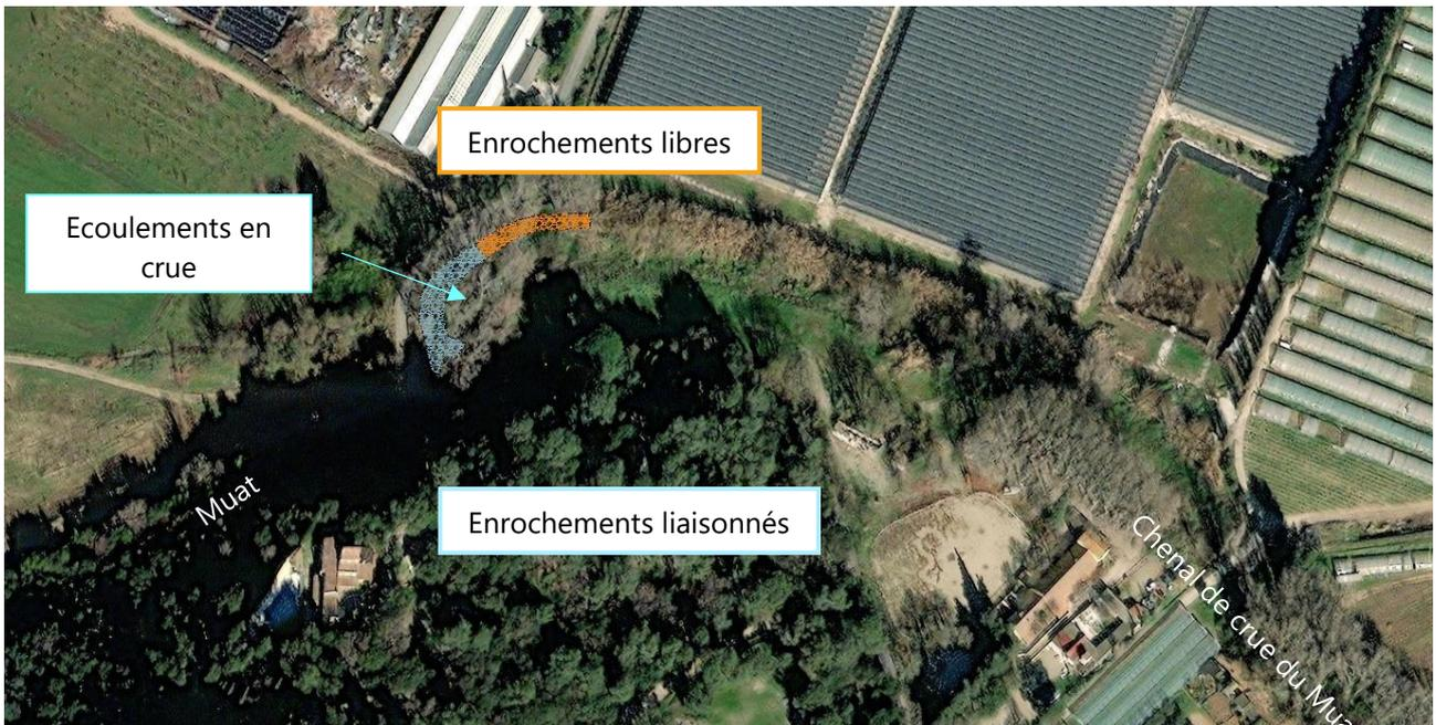
**FIGURE 17 : PASSAGE A GUE - AMENAGEMENT EN ENROCHEMENTS (EGIS, 2023)**
