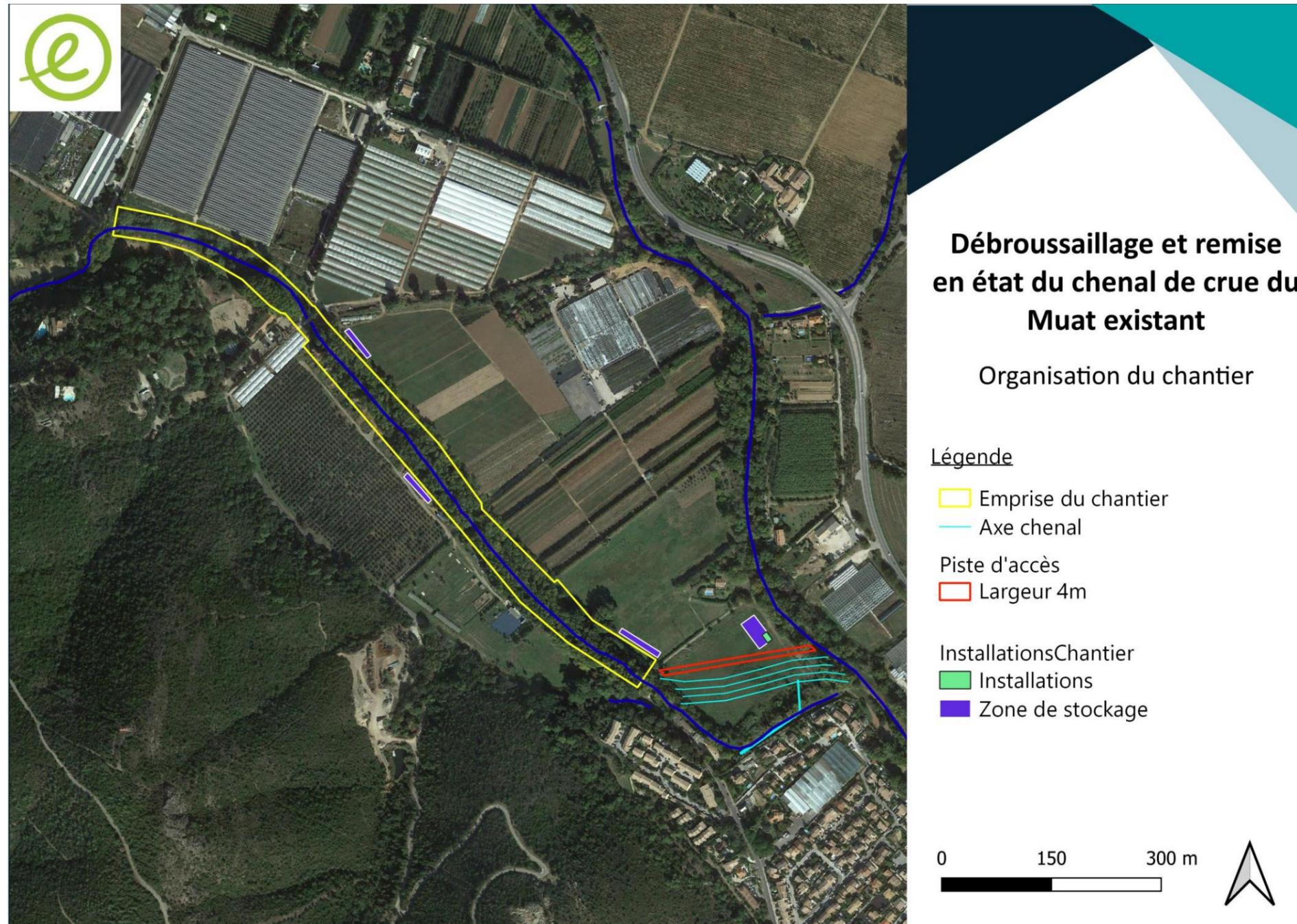
FIGURE 8 : DEBROUSSAILLAGE ET REMISE EN ETAT DU CHENAL DE CRUE DU MUAT EXISTANT (EGIS, 2023)
