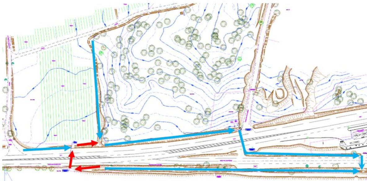
Figure 19 : Principe d'écoulement général de la zone (Source : Note technique – Artelia)
