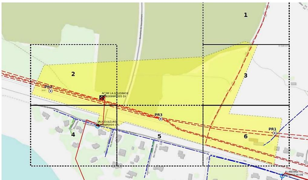
Figure 23 : Réseau électrique aux abords du site (Source : Note technique – Artélia)
