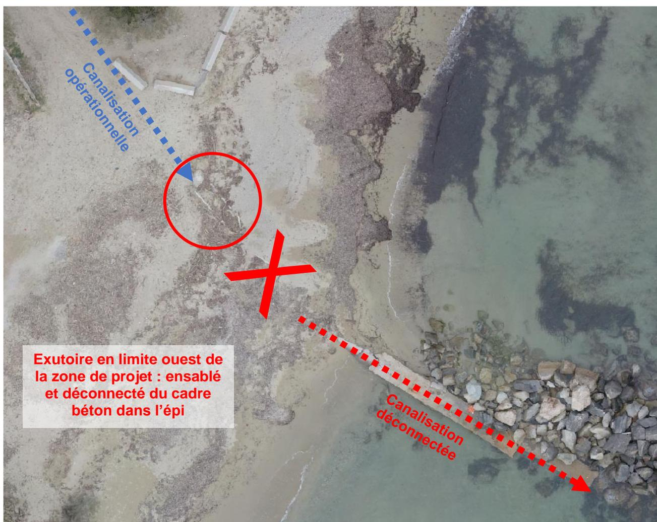
Figure 38 - Exutoire en limite ouest (terminaison d'un cadre ouvert puis busé, démarré également au niveau de la D559)
