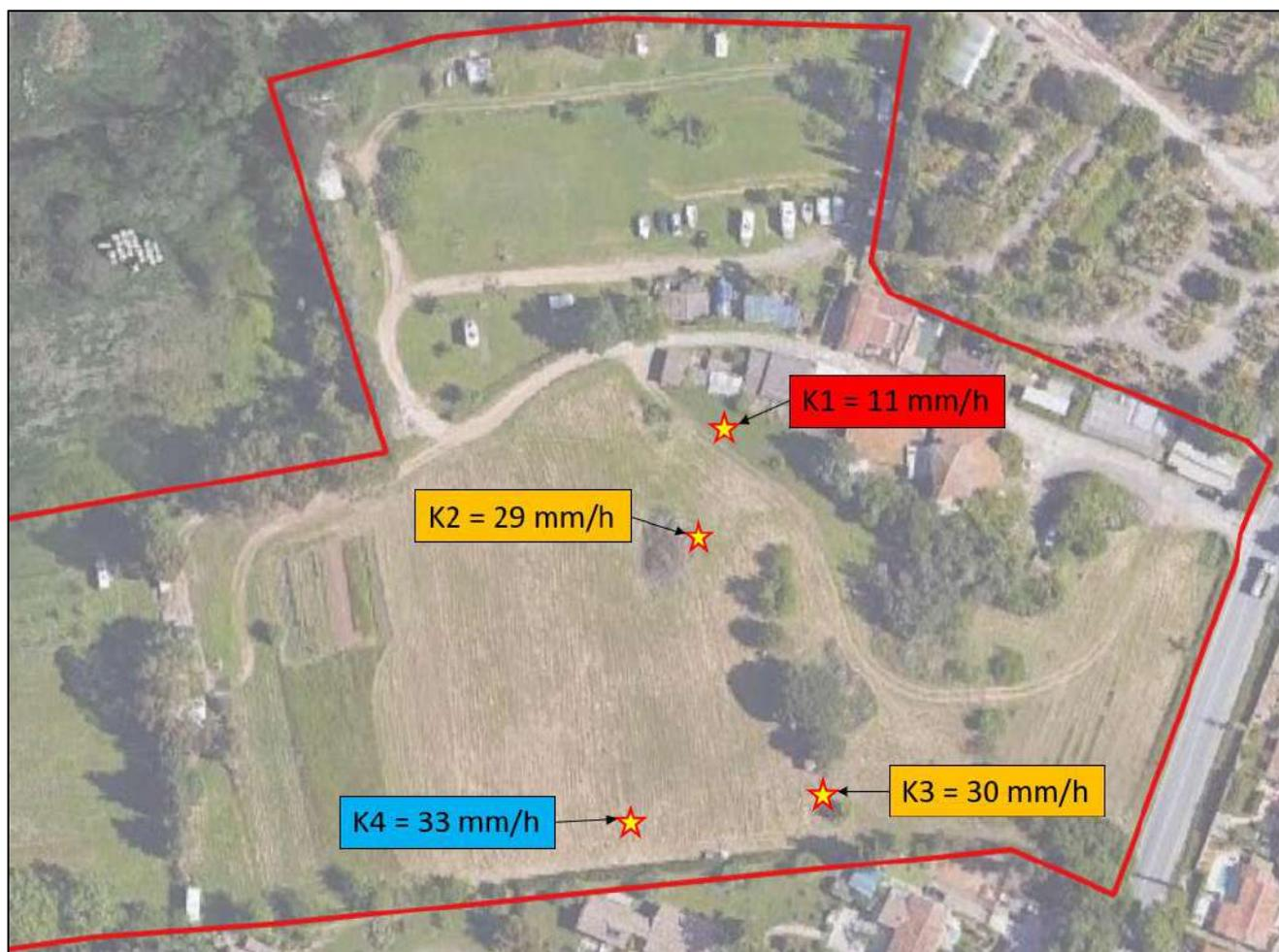
Illustration 11 : Localisation des tests de perméabilité sur le projet
