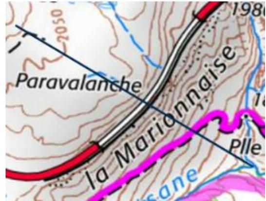
Il est important de souligner que la présence d'éboulis sur le site de la galerie est prise en compte dans la définition de l'action sismique en majorant de 20 % le coefficient d'amplification topographique suivant l'Annexe A de l'Eurocode 8-5 [8]. Ainsi, on pourrait retenir  $S_T = 1.2 + 20\% = 1.4$  sur les éboulis.
