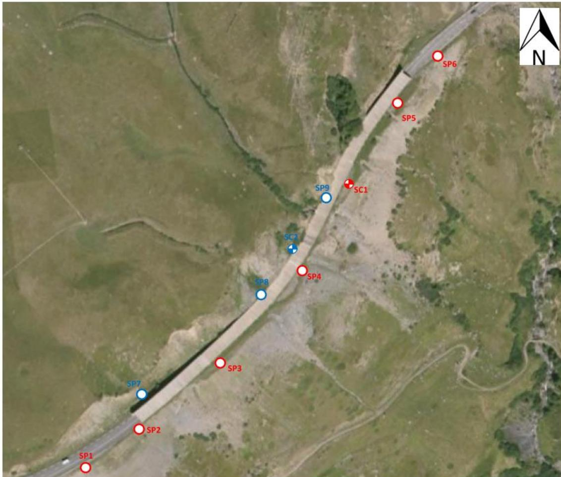
**Figure 1** : Plan d'implantation des sondages géotechniques réalisés par ERG en septembre 2021
