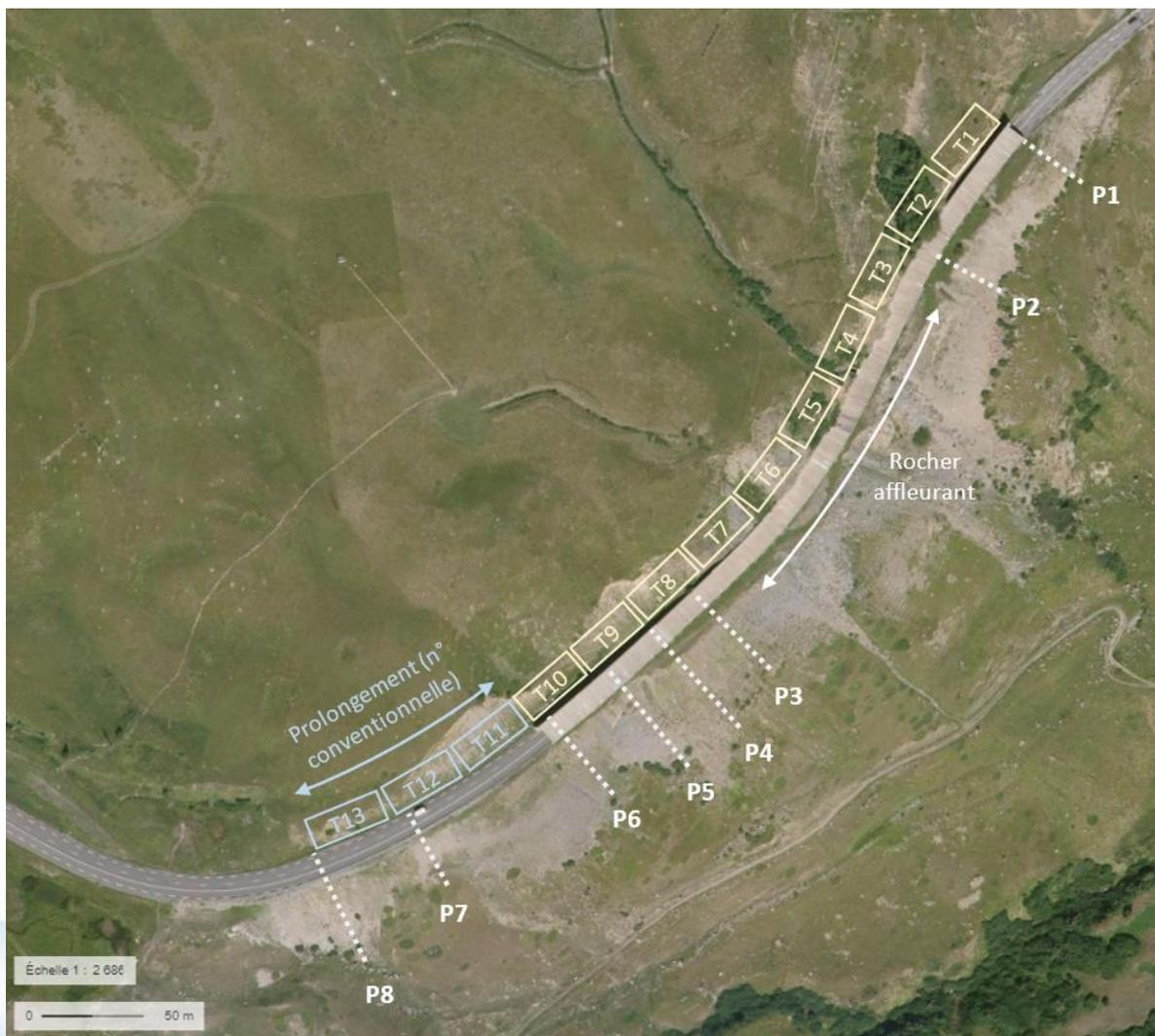
Figure 36 : Profils sélectionnés pour l'analyse de stabilité
