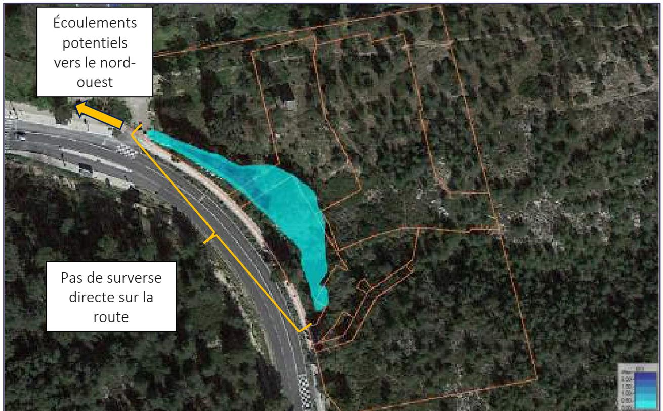
Figure 34. Cartographie des hauteurs de submersion calculée au droit du projet (contours orange) lors de l'épisode d'octobre 2021
