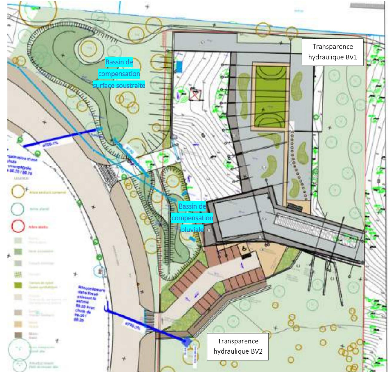
Figure 61 : schéma de principe des ouvrages de gestion des eaux pluviales – ouvrages de compensation
