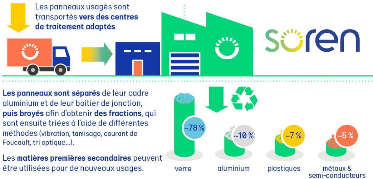
Figure 20 - Le traitement des panneaux photovoltaïques par SOREN. Source : SOREN.
