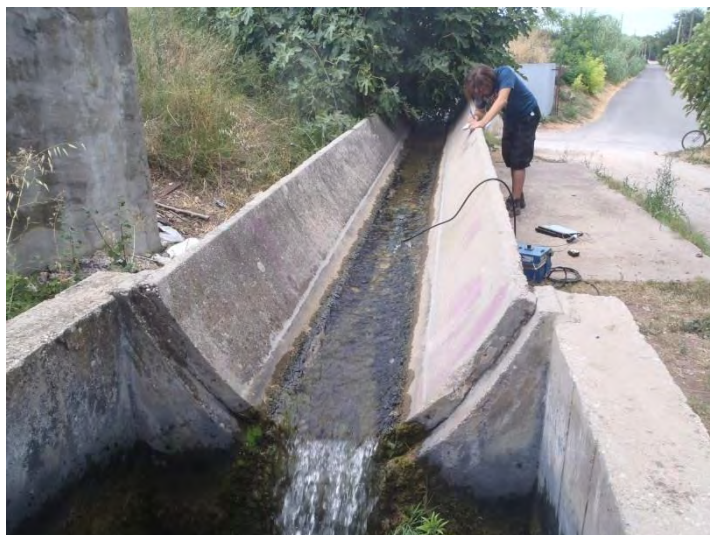
Illustration n°16: Photographies d'une mesure en continu des débits de restitution sur le canal d'irrigation de l'ASA de la Ferrage à Solliès-Pont
