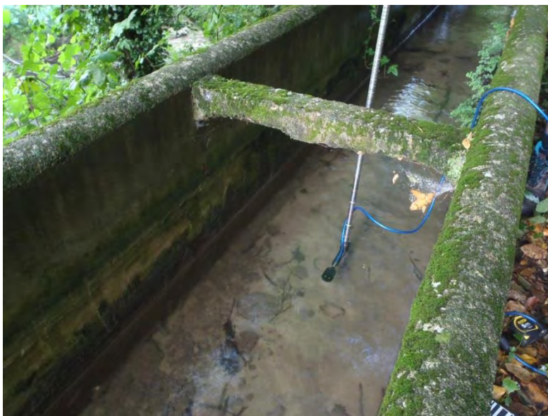
Illustration n°13: Photographie d'un jaugeage ponctuel sur le canal d'irrigation de l'ASL Pont-Peiresc à Belgentier
