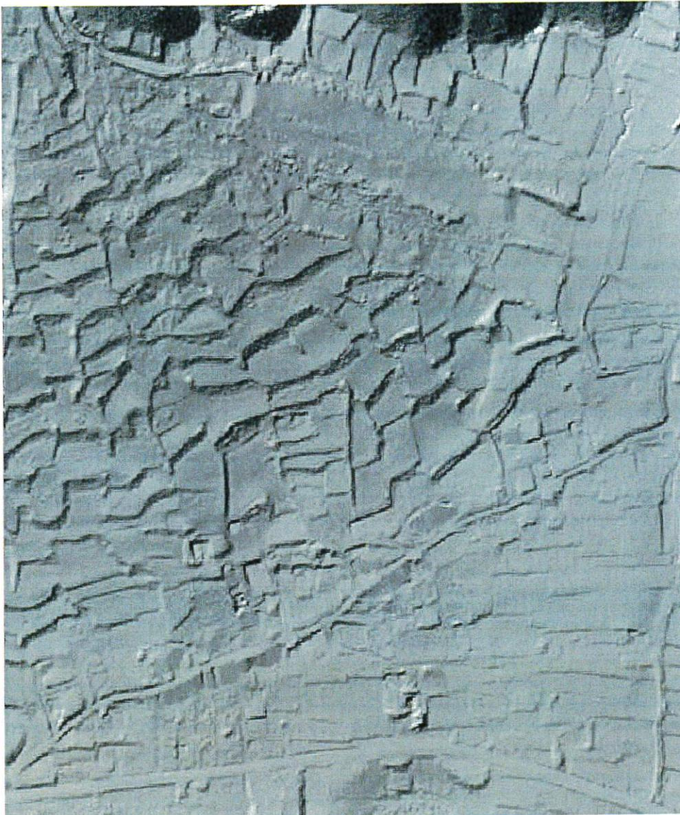
*MNT utilisé dans le modèle (MNT de 2019 au pas de 50 cm ramené à un pas d'1,5 m)*
