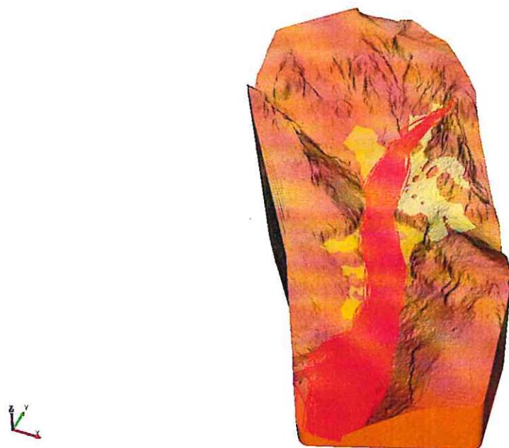
Figure 11: Trajectoires calculées lors de la modélisation pour un bloc de 10 m 3 sur la base de 10 000 départs.
