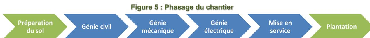
Les principales étapes du chantier concernent la mise en place de l'infrastructure et le câblage de l'ensemble des éléments.
