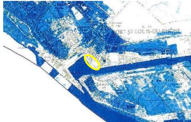
Figure n°3 – Aléa submersion marine par la côte 1.70m NGF
