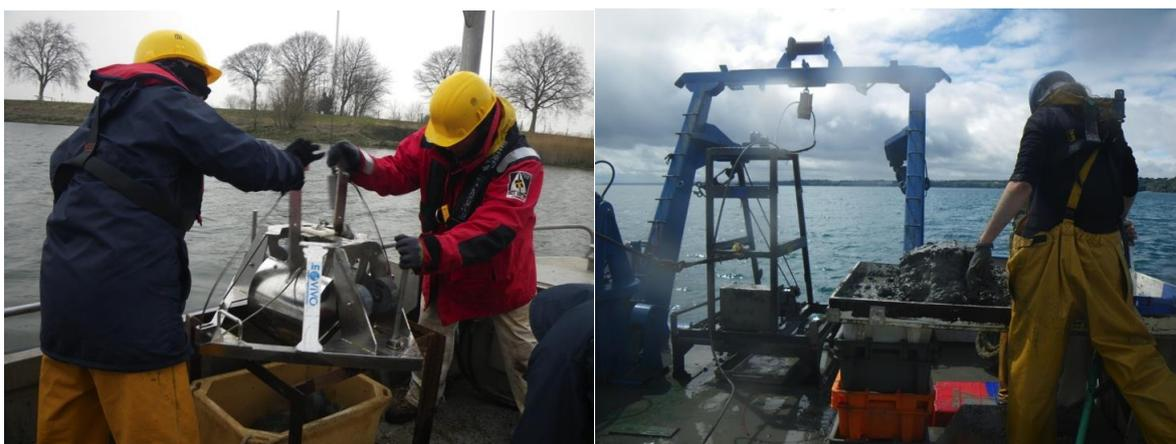
Figure 21 : Utilisation de la Day Grab et de la benne Mini-Hamon (setec in vivo).
