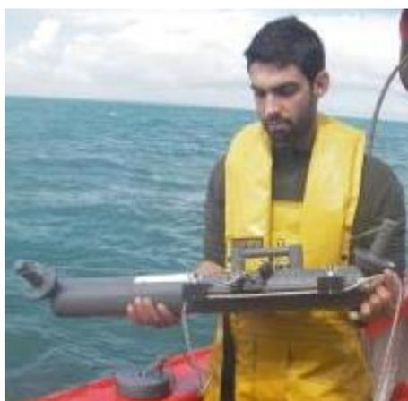
Figure 22. Bouteille NISKIN armée et prête à l'emploi (setec énergie environnement)
