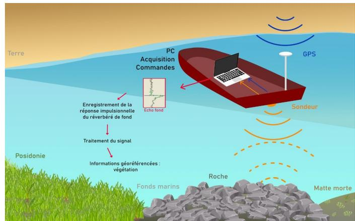
Figure 18 : Schéma de principe du système de sondage bathymétrique géo-référencé
