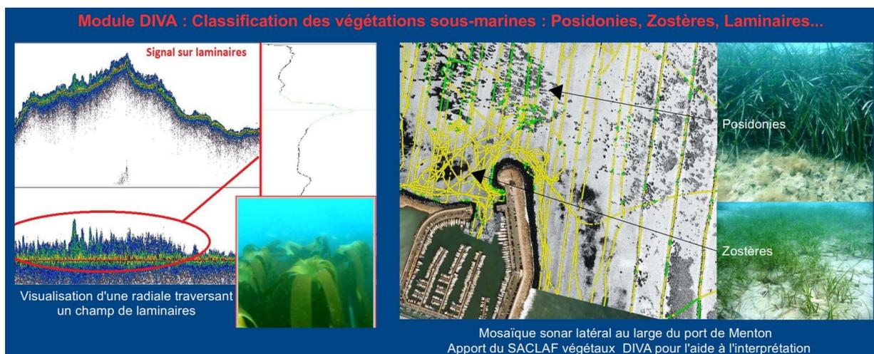
Figure 19 : Suite logicielle permettant la classification des végétations sous-marines (Module DIVA)
