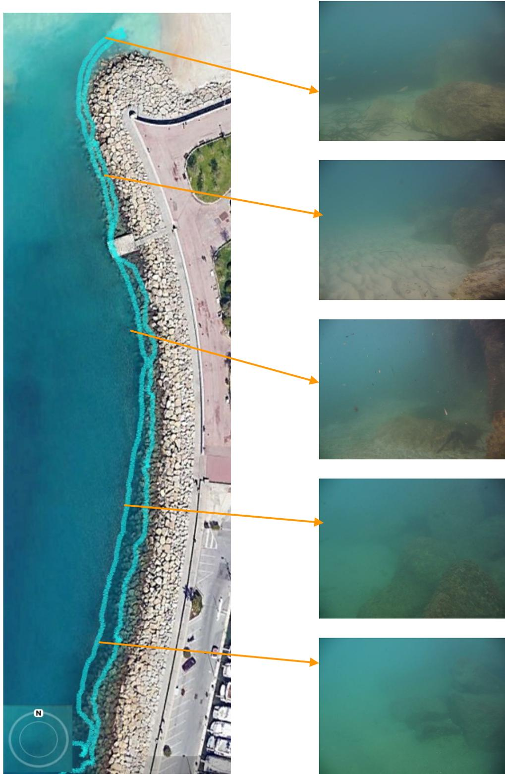
Figure 55 : Transect d'observation du fond en limite inférieure de la digue
