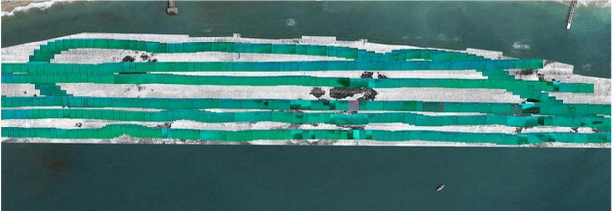
Figure 23 : Exemple de levé vidéos géo-référencée : Extraction régulière de photographies géo-référencées
