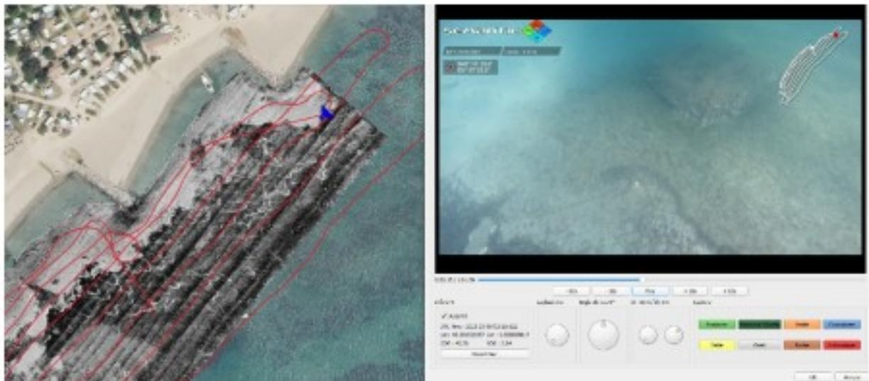
Figure 33 : Illustration de la phase de traitement des données vidéos : Système ENO intégré dans QGIS.
