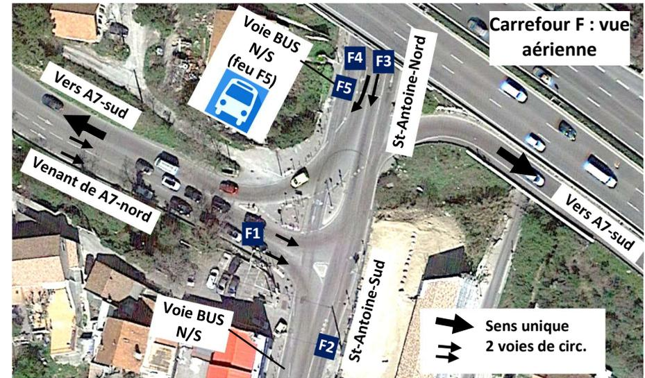
Le cycle est de 80 secondes, que ce soit avec ou sans la phase bus (2 phases → 3 phases). Lorsque la phase bus est escamotée, le feu F4 bénéficie de 12 secondes supplémentaires (la durée de vert de F3 et F3' n'est pas affecté par la phase bus).
