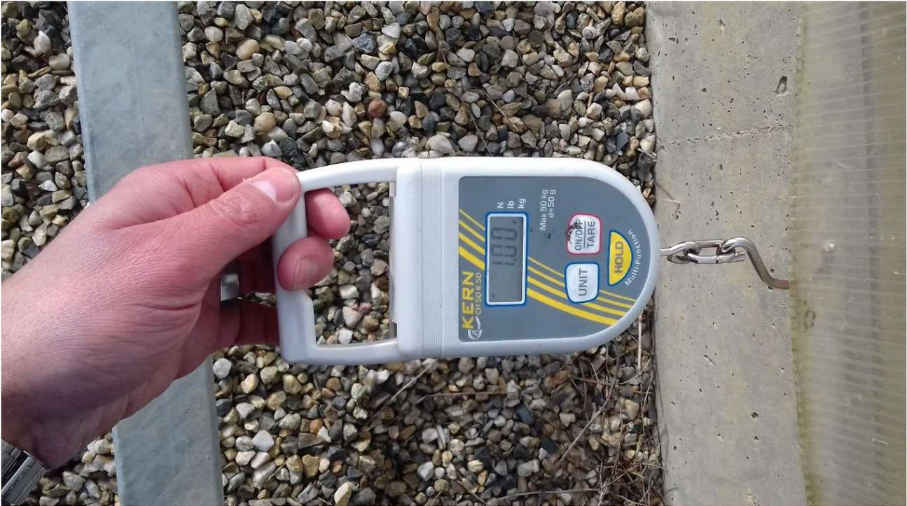
Figure 3 : Test de pression sur paroi fusible (Source: REDEN)
