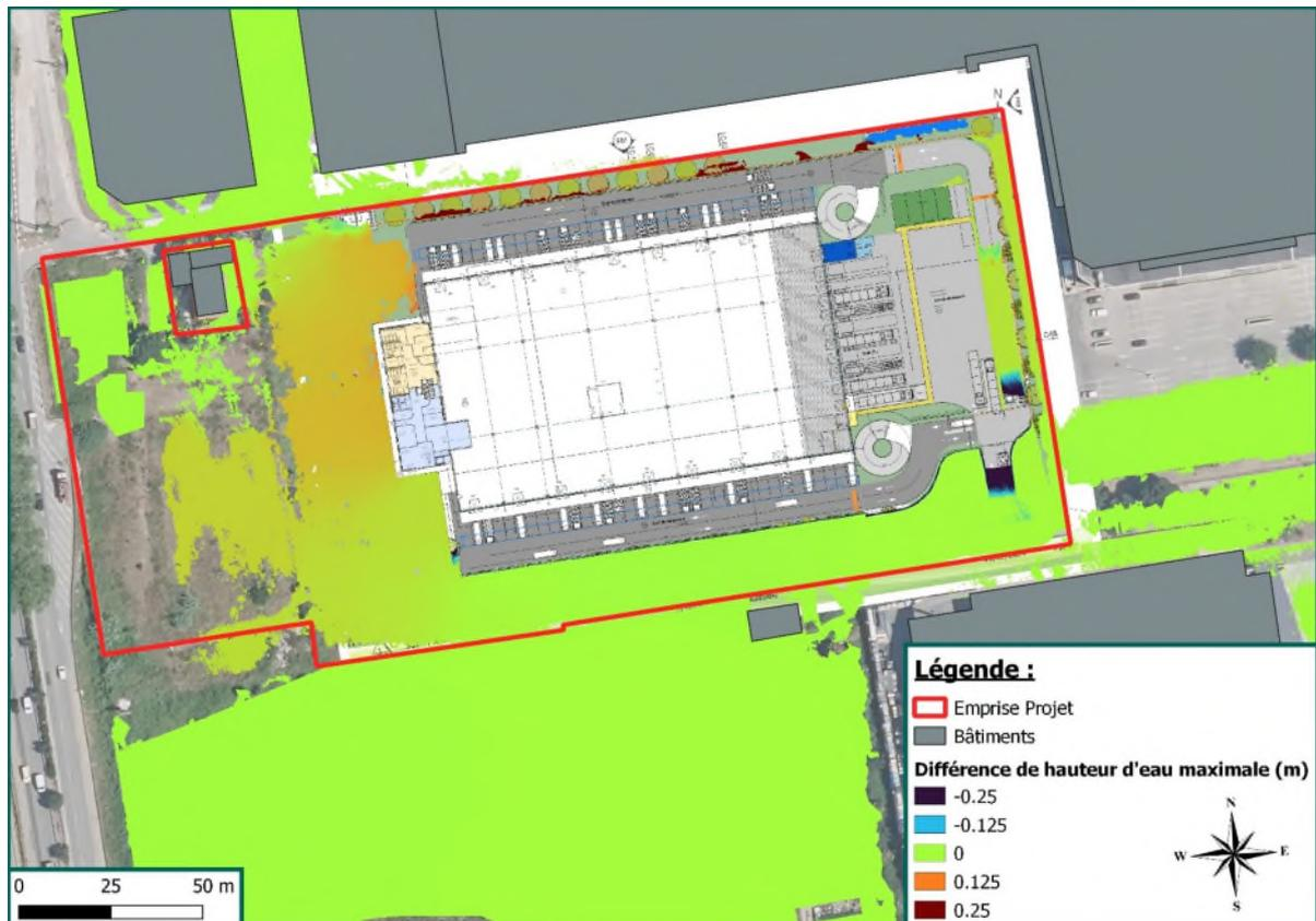
Figure 20 : Différences entre les hauteurs d'eau maximales de l'état actuel et de l'état projeté – Evènement de crue centennale du Var, crue décennale des vallons, avec rupture de digue des vallons
