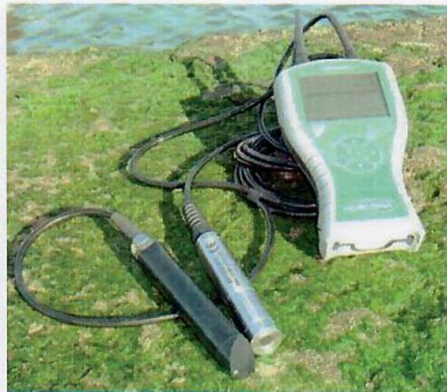
Figure 7 : Exemple de sonde turbidimètre pour mesures *in situ* de la turbidité de l'eau
