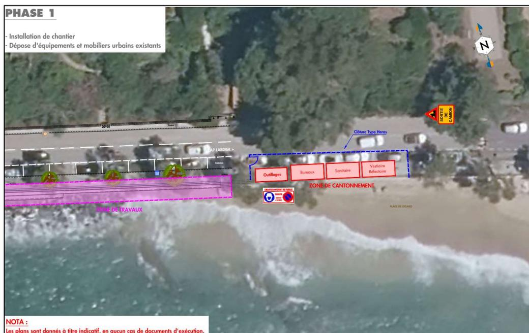
Figure 63 Implantation de la zone de baraquements de chantier et de la zone de travaux
