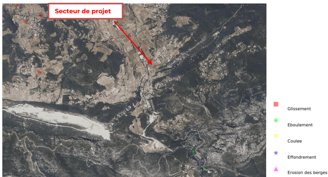
Figure 14 : Mouvements de terrain historiques présents à l'échelle de la commune et à proximité du secteur d'étude (Géorisques)
