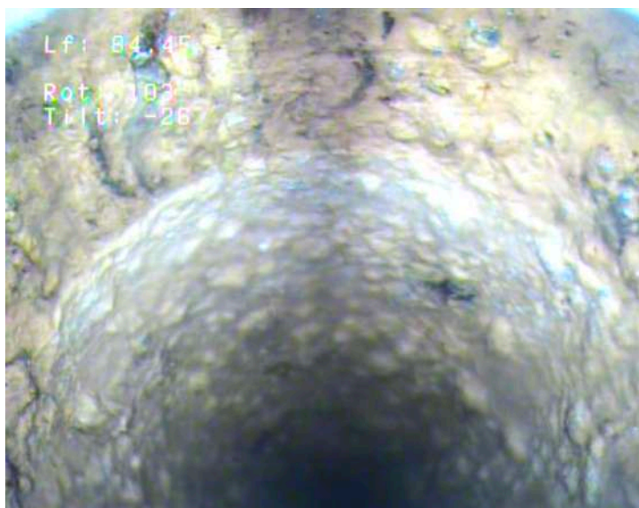
Profondeur 84,45 mètres. Dépôt correspondant à un niveau d'eau plus haut qu'actuellement.
