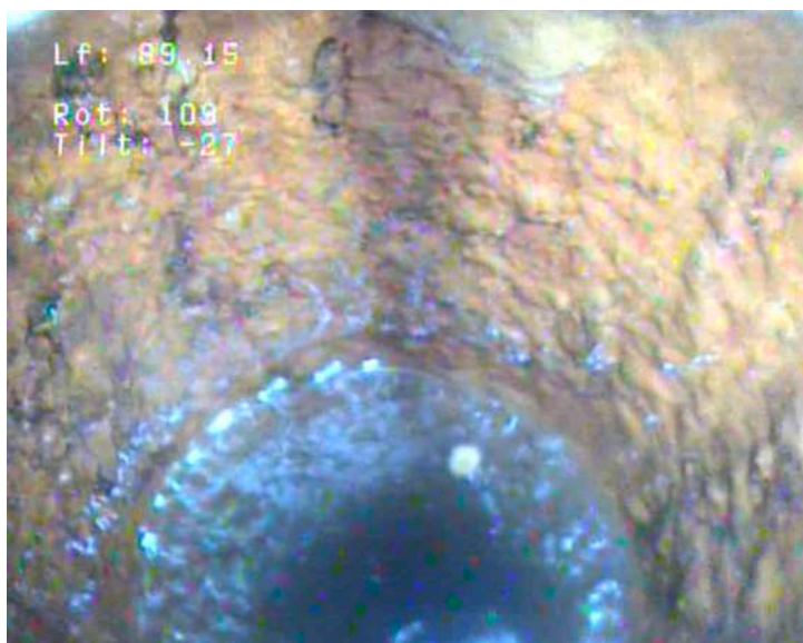
Profondeur 89,15 mètres. Niveau d'eau forage.
