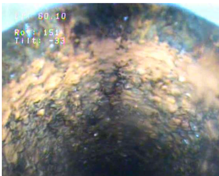
Profondeur 60,10 mètres. Dépôt sur tubage important.
