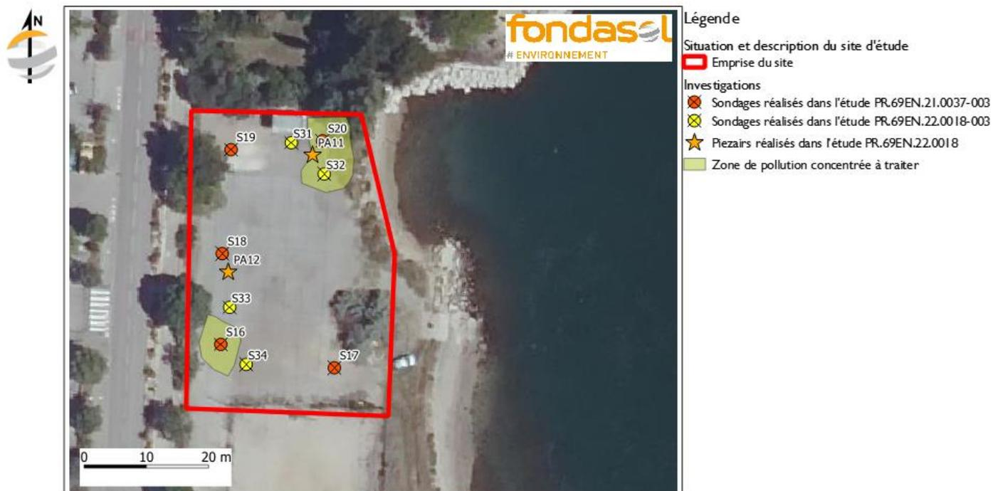
Figure 22 : Délimitation de la zone de pollution concentrée à traiter (analyse statistique)
