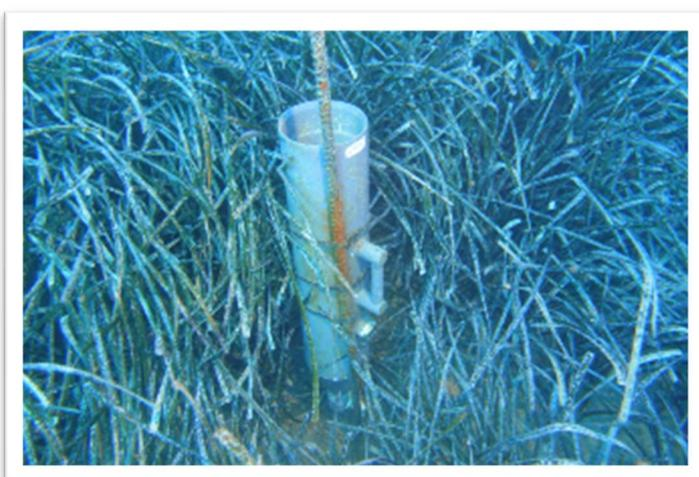
Figure 59 : suivi sédimentaire par piège à sédiments.
