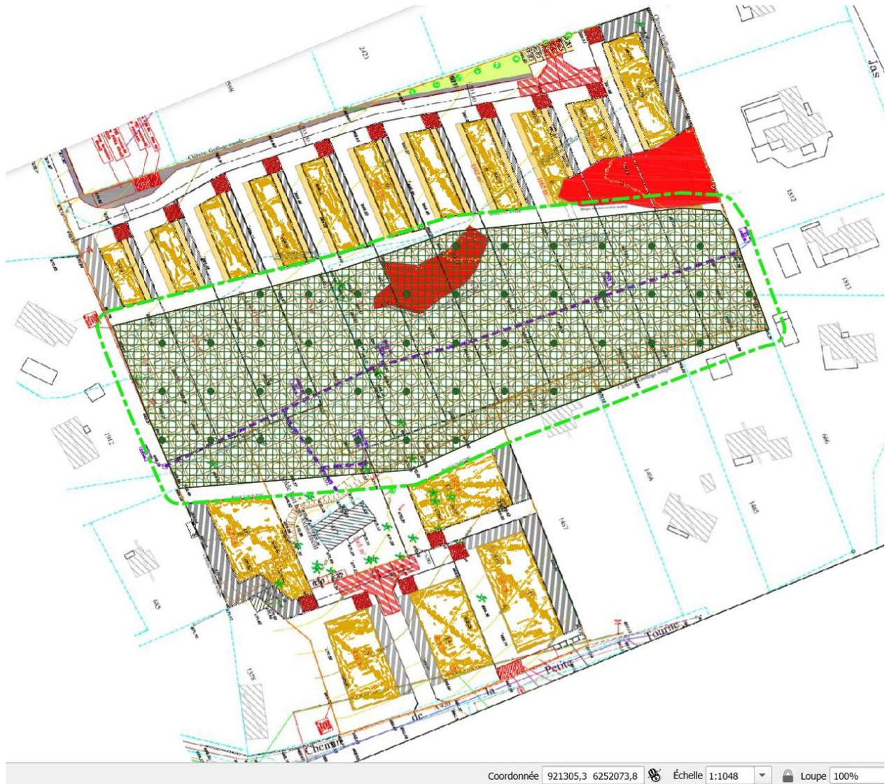
**Figure 7 : Plan de composition vis-à-vis de l'EBC et du système racinaire de ses arbres**
