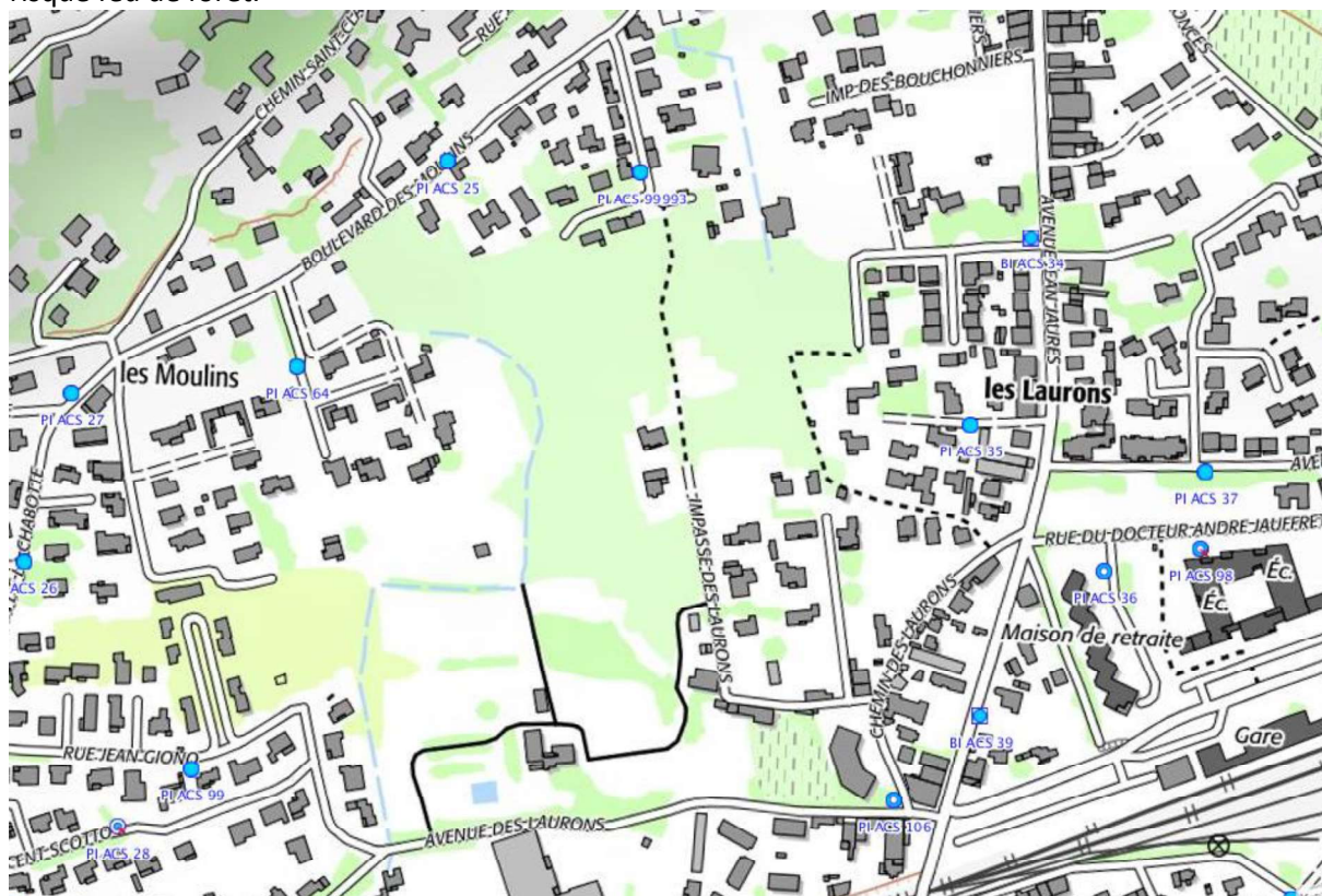
Les poteaux incendie ● présents autour du site (Source Remocra).
