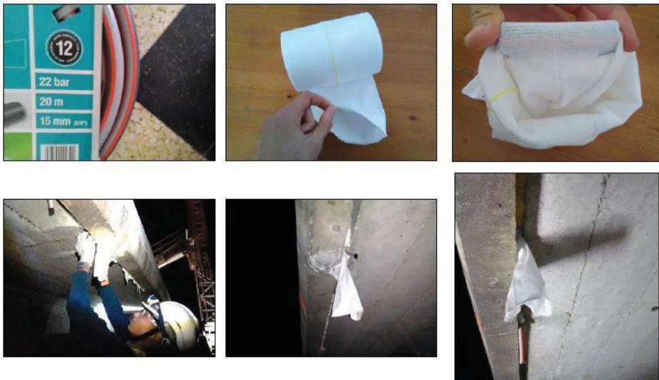
Matériel utilisé pour créer un SAR (en haut) et mise en place sur les fentes de l'ouvrage (en bas)
