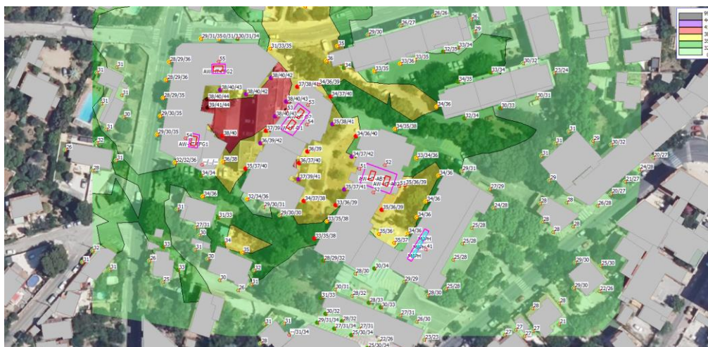
Figure 10 : Résultats de simulations, niveaux en dB(A) avec des équipements techniques moins bruyants (82 dB(A) max) - L'objectif maximum de bruit particulier en période nocturne (période la plus contraignante) est de 38.5 dB(A).
