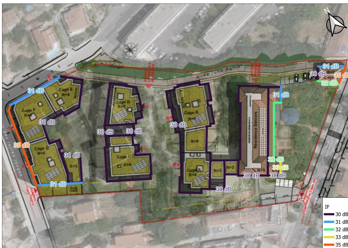
Figure 3 : Objectifs d'isollements de façades du projet.
