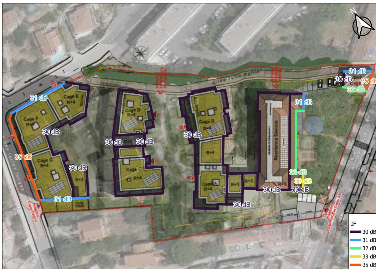
Figure 3 : Objectifs d'isollements de façades du projet.
