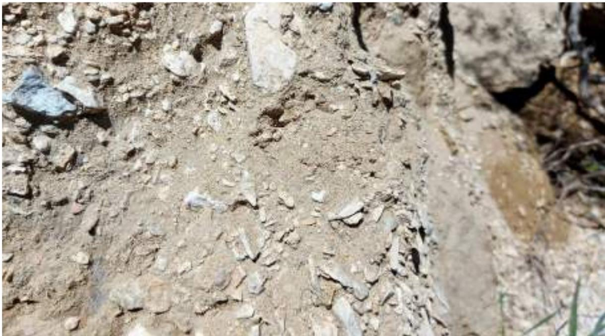
Le talus est constitué d'un matériau de type conglomérat à matrice sablo-limoneuse, à induration variable.
