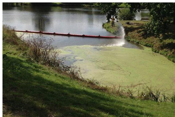
Figure 7 - Exemple des barrages flottants anti-pollution
