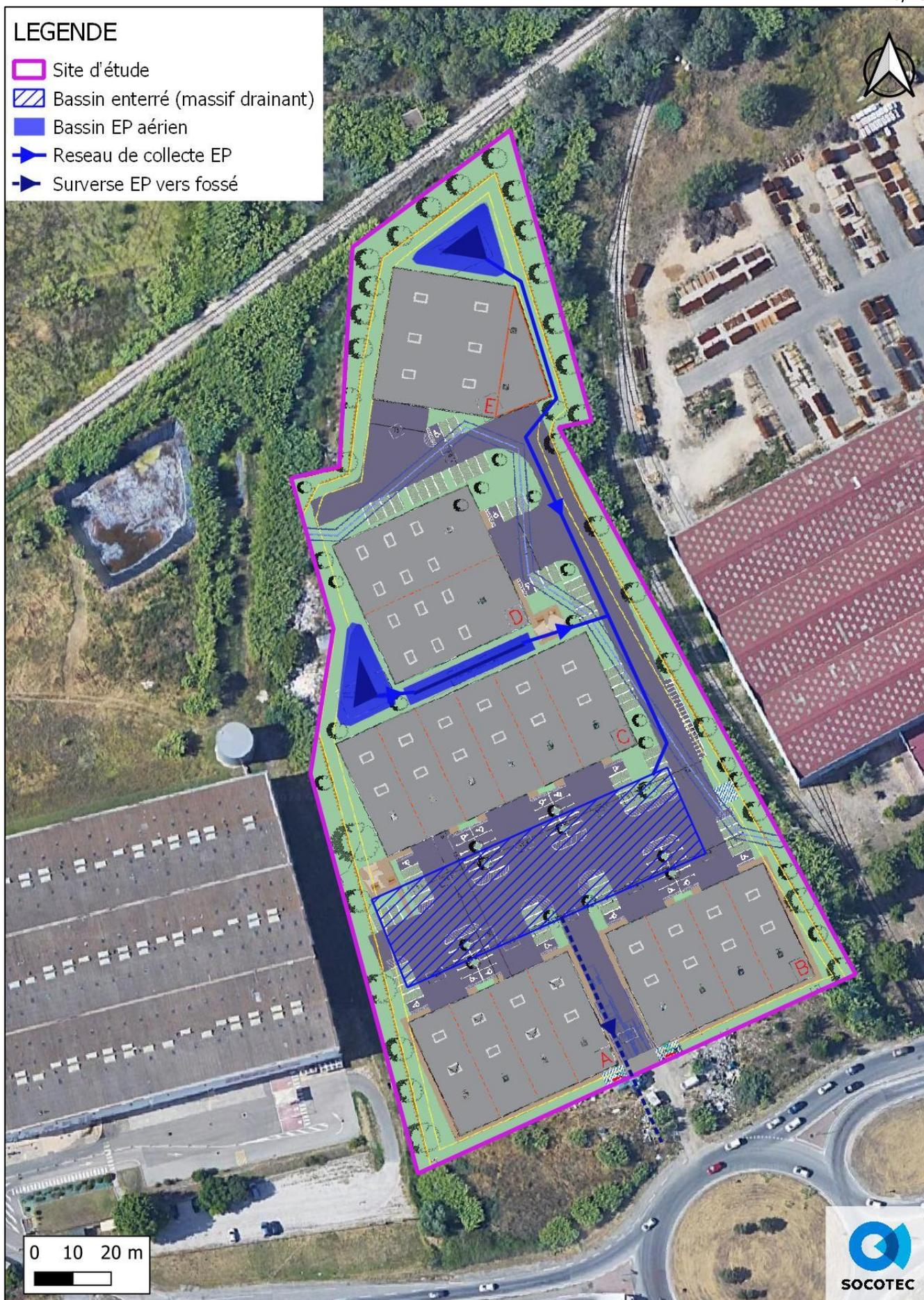
Figure 7 : Schéma de principe d'assainissement des eaux pluviales
