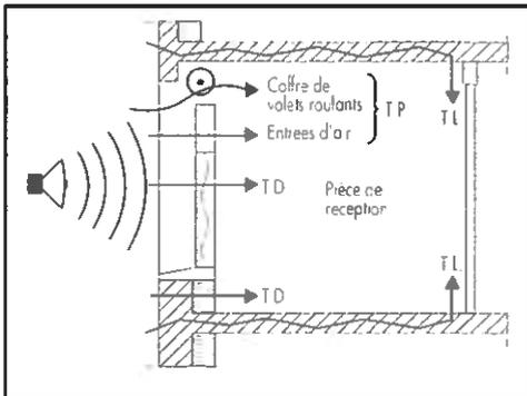
Ce critère fixe les degrés d'isolements à respecter pour les façades des bâtiments ; la transmission se fait de l'extérieur vers l'intérieur des locaux. Les différentes voies de transmissions habituellement rencontrées dans le bâtiment sont synthétisées sur la figure ci-dessous.
