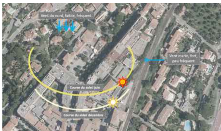
Principe de ventilation traversante des classes
