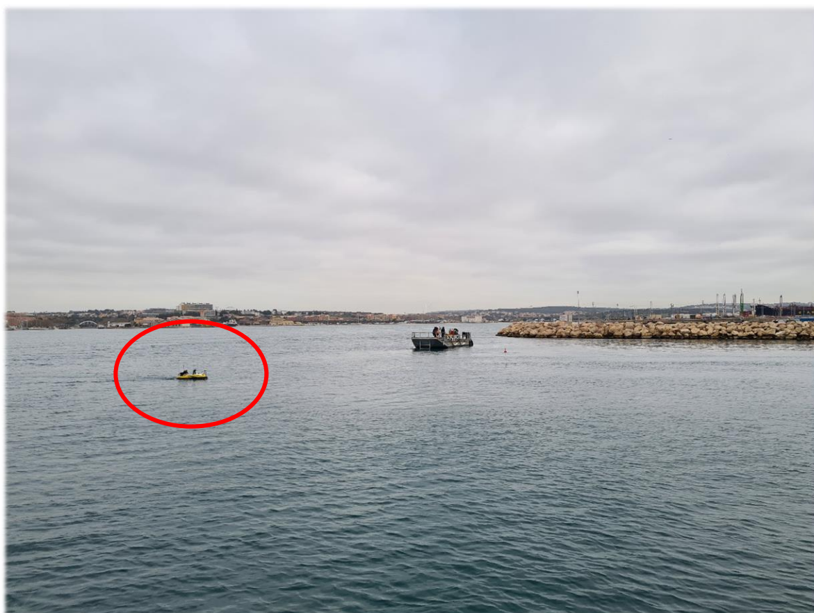
Photo 6 Drone bathymétrique en cours acquisition de données
