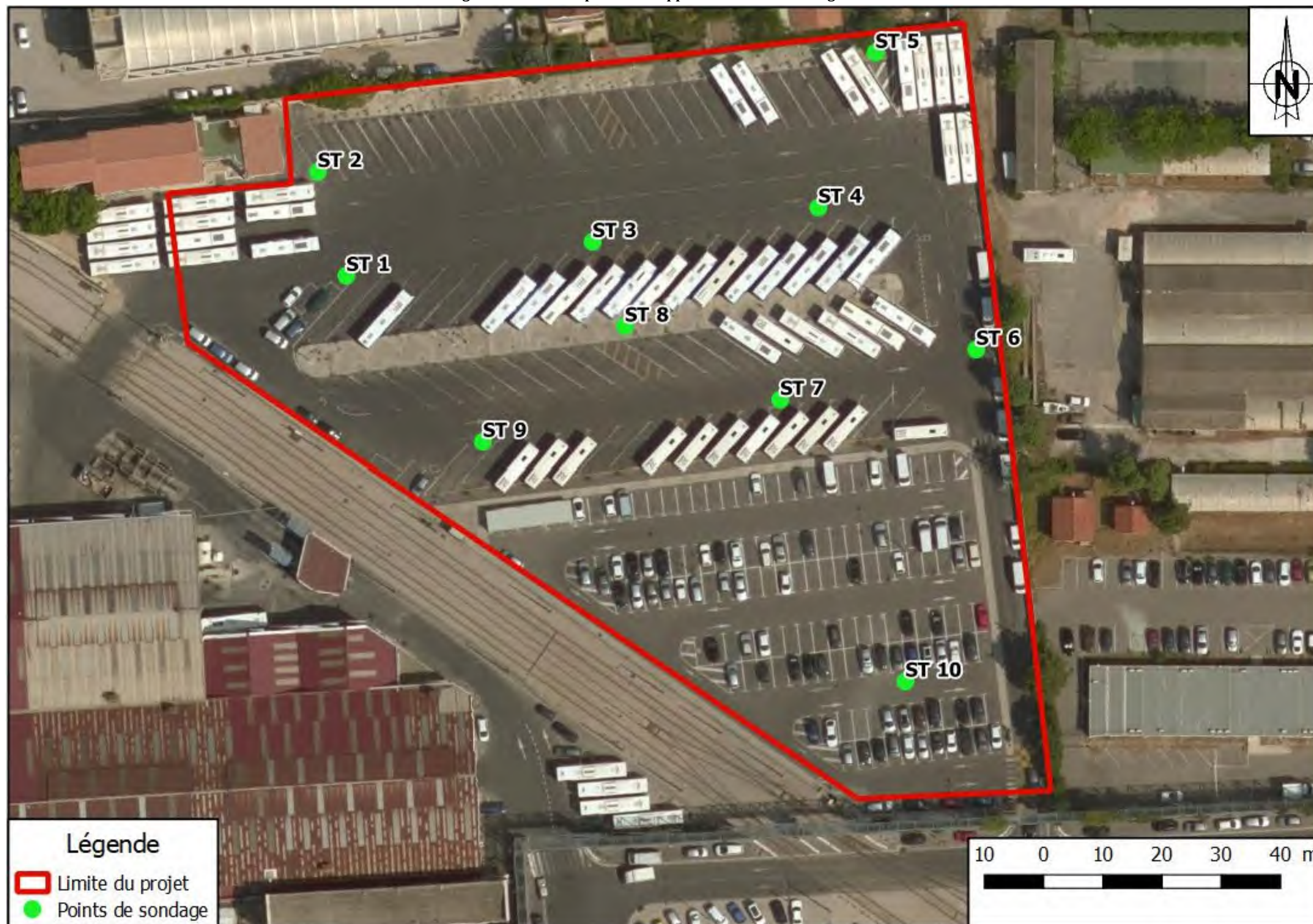
Figure 8 : Plan d'implantation approximative des sondages
