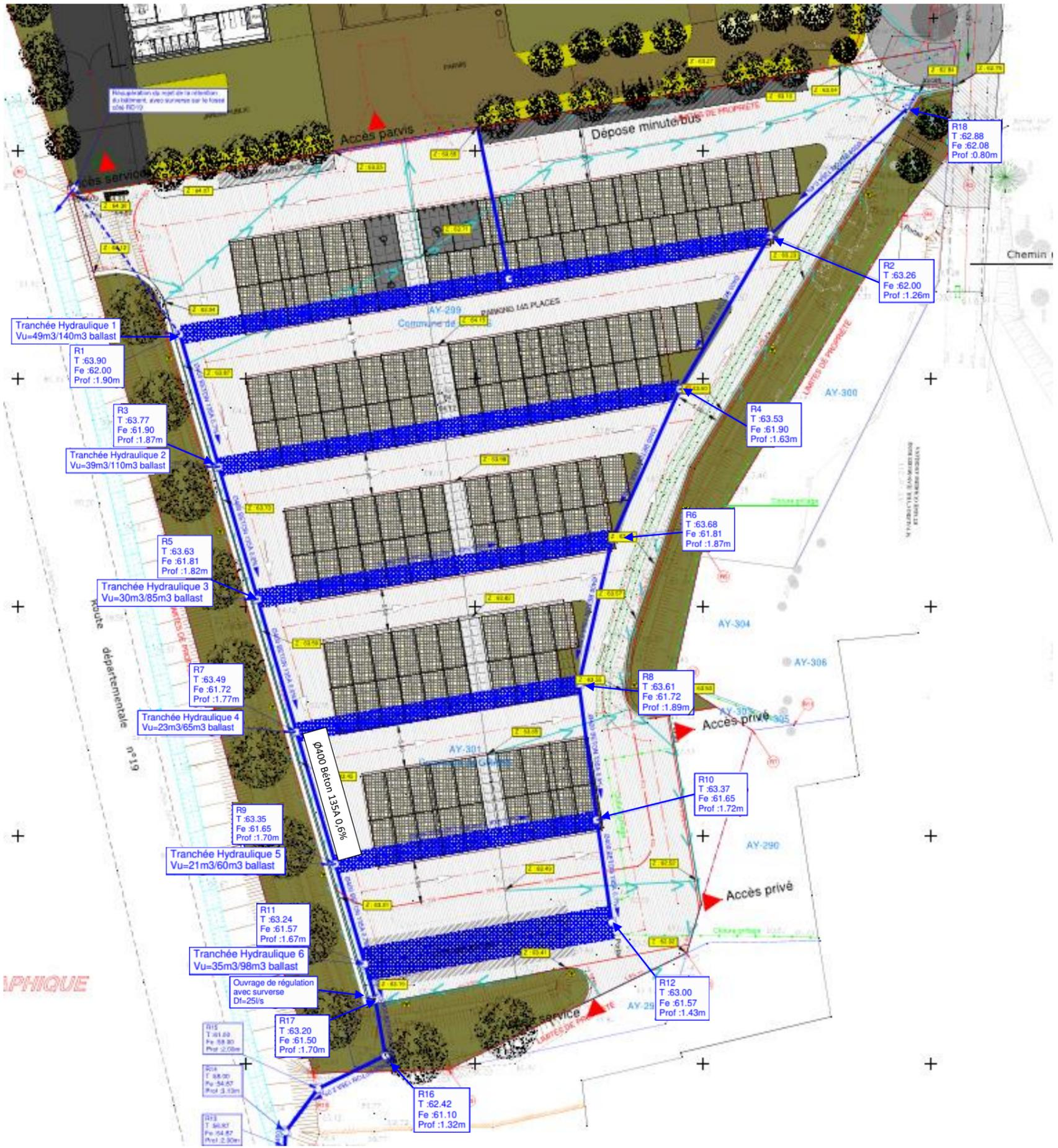
Illustration 19 : Emplacements des tranchées hydrauliques de gestion des eaux pluviales du parking au sud du projet (LLA architectes&associés, 2024)
