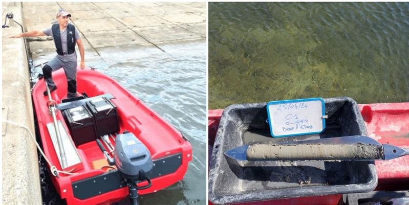
Figure 26 : Matériel utilisé pour les prélèvements des sédiments de L'étang de Berre (CISMA Environnement)
