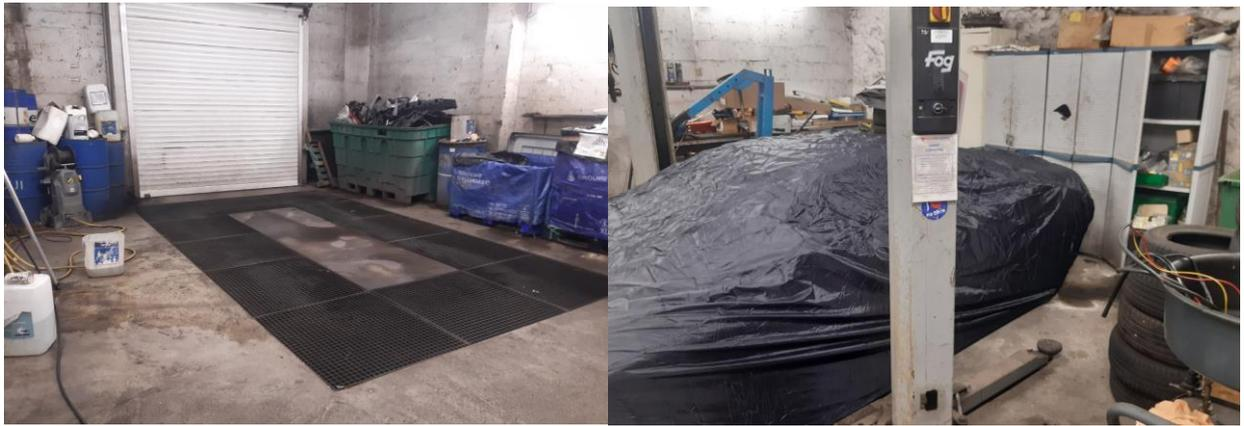
**Figure 4 : aire de lavage et pont de réparation pour véhicule. Odeur d'hydrocarbure et traces de souillures au sol.**
