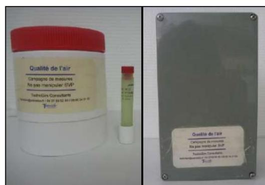
Figure 58 : Réceptacle, tube passif pour le NO<sub>2</sub> et micro-capteur laser pour les particules
