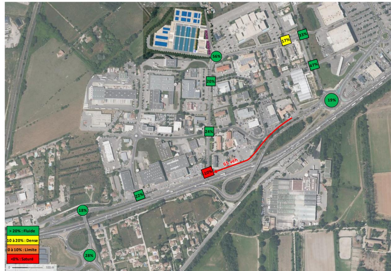
En jour ouvré, quasiment tous les carrefours maintiennent des réserves de capacité supérieures à 20% correspondant à une circulation fluide. Seul le carrefour 4 déjà saturé montre une valeur logiquement toujours négative (-10%) avec une remontée aggravée (65 véhicules au lieu de 25 en situation actuelle) sur le chemin du Pégord en raison de l'augmentation du trafic prioritaire sur le chemin des Petits Rougiers.
