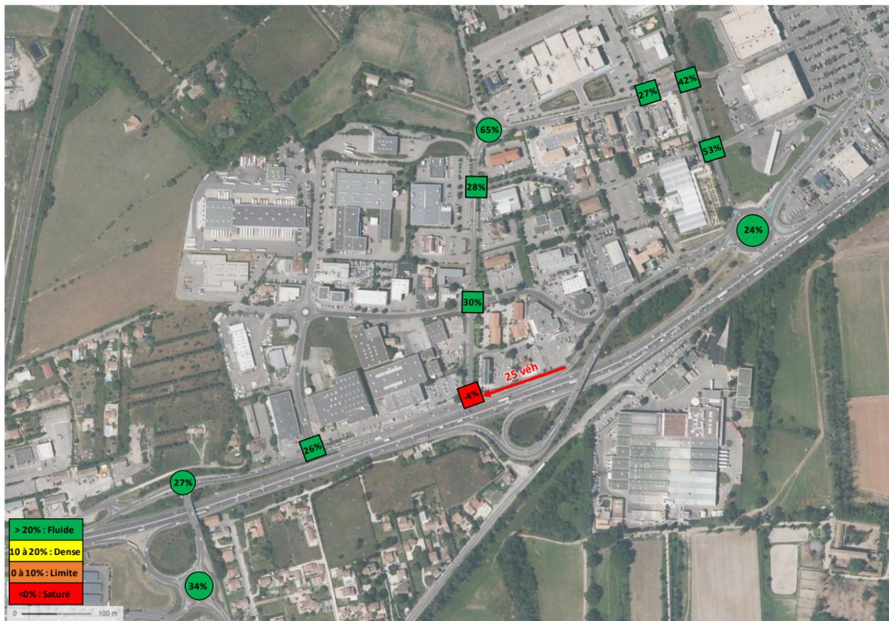
En jour ouvré, quasiment tous les carrefours montrent des réserves de capacité supérieures à 20% correspondant à une circulation fluide. Seul le carrefour 4 montre une réserve de capacité négative (-4%) avec une remontée de 25 véhicules en attente d'insertion au STOP sur le chemin du Périgord.
