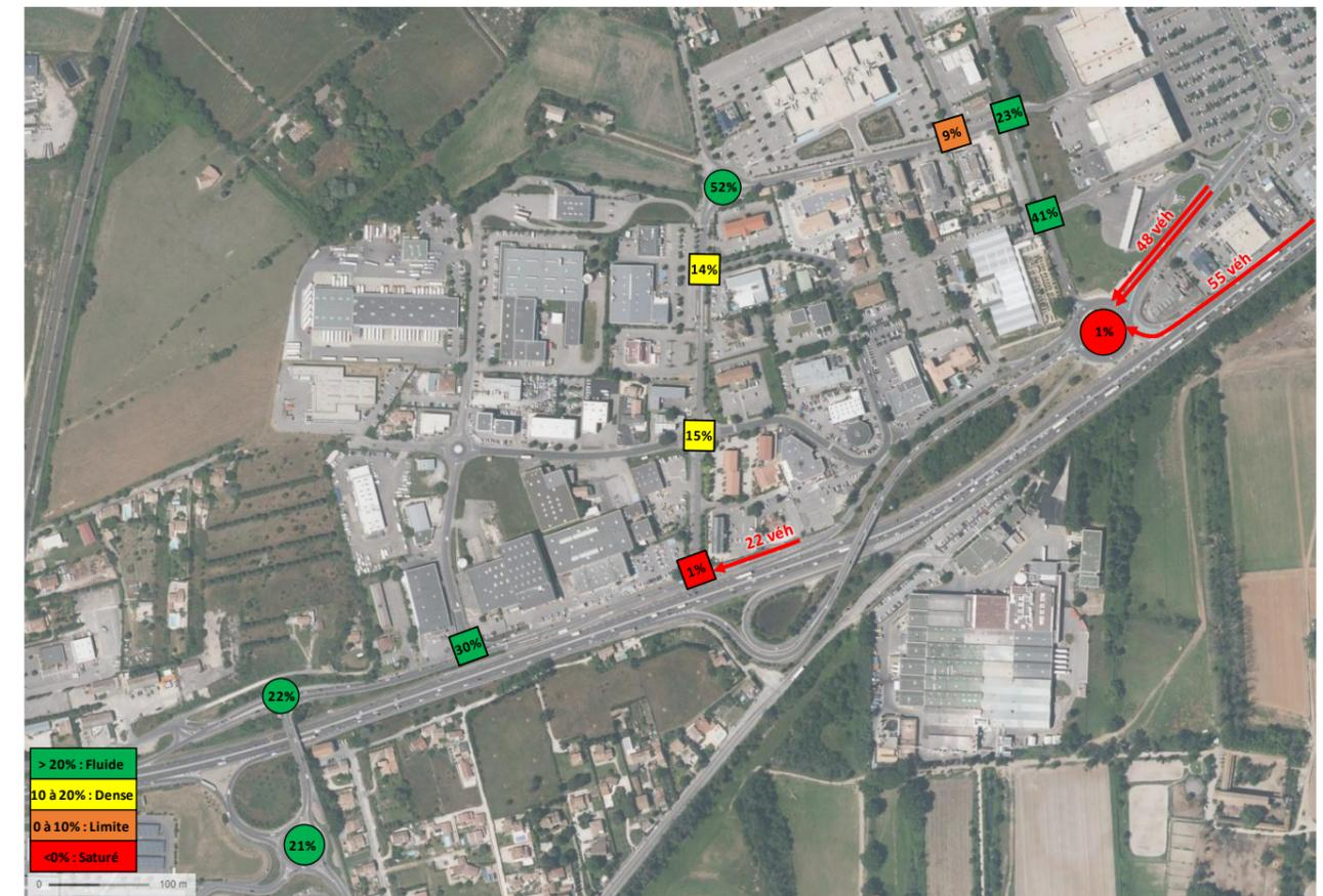
Le samedi, on retrouve la même remontée de véhicules chemin du Périgord, et on observe des remontées supplémentaires sur la sortie RD225 et sur l'avenue Louis Braille. On note par ailleurs que les réserves de capacité sont faibles sur 2 carrefours du chemin des Petits Rougiers et 1 carrefour de l'avenue de Saint Tronquet.
