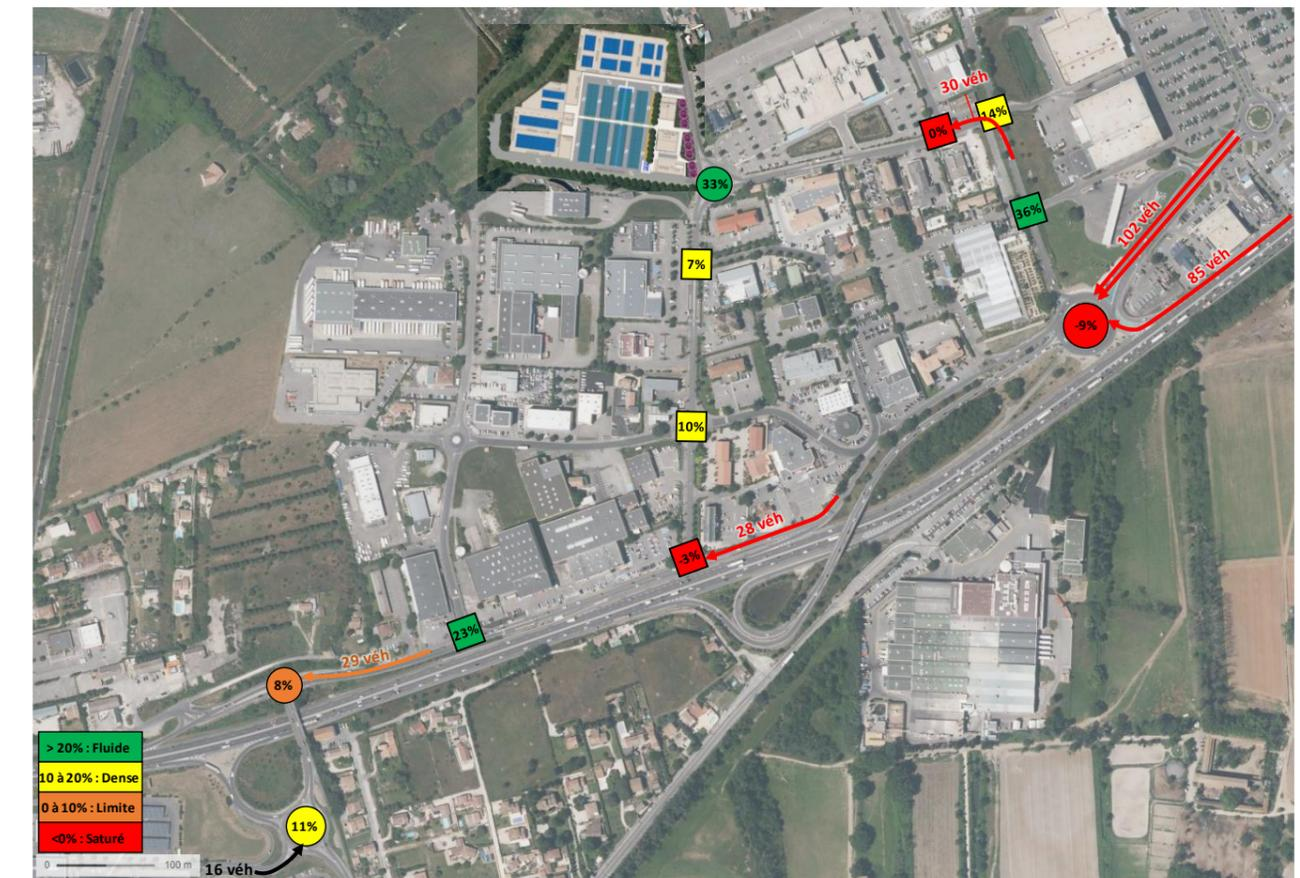
Le samedi, les remontées de véhicules qui existent déjà en situation actuelle sont logiquement aggravées (chemin du Pégord, giratoire RD225). Deux nouvelles remontées font leur apparition : en entrée sur la rue Graham Bell, et en sortie au mini giratoire du Pégord. Dans les deux cas il s'agit d'une remontée de 25 à 30 véhicules qui n'atteint pas le carrefour en amont, cette situation peut être acceptée pour une heure de pointe du samedi.
