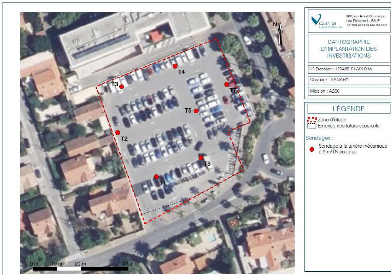
Figure 2 : Plan d'implantation des sondages – Source : Etude hydrogéologique SOLER-IDE
