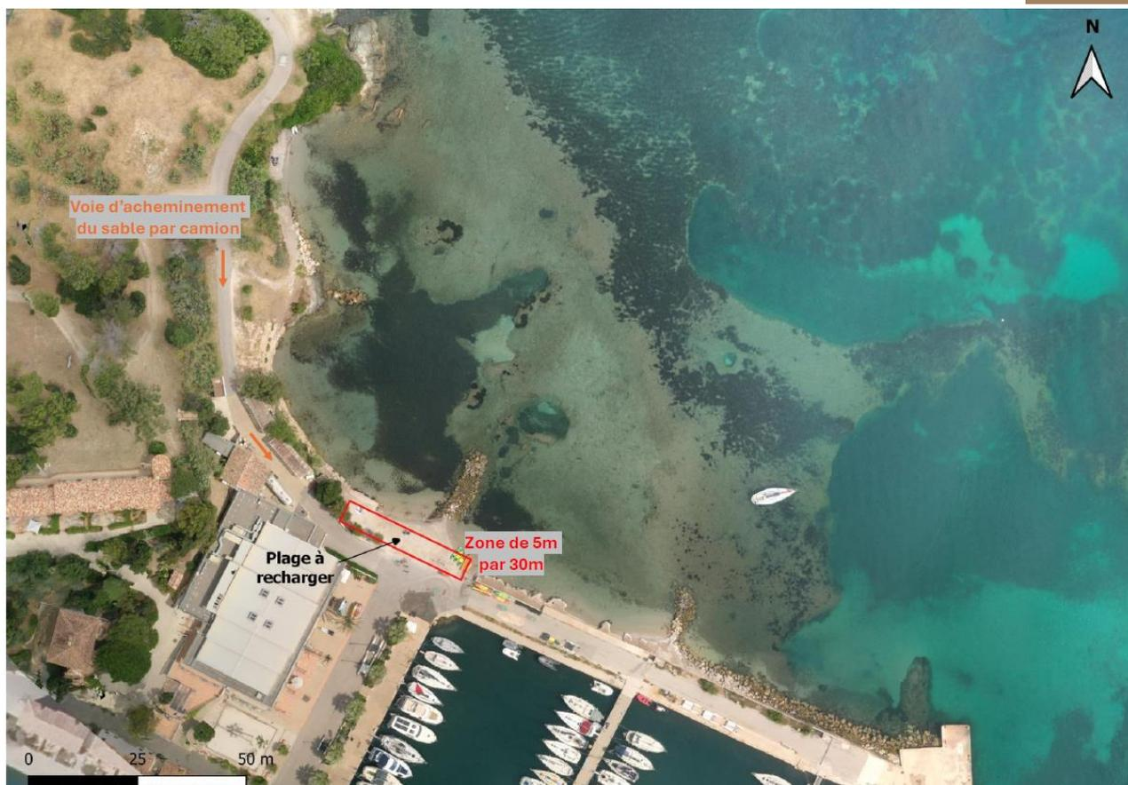
Figure 4 : Emprise de rechargement et voie d'acheminement du sable
