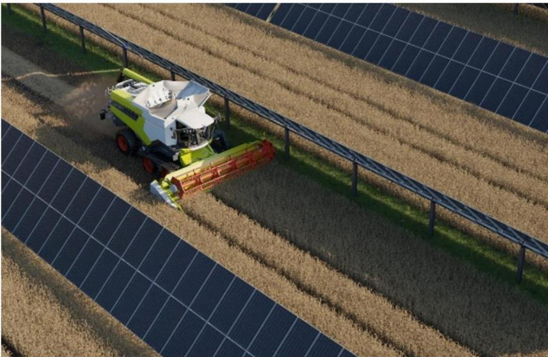
Figure 5 : Pilotage des trackers de l'ombrière de culture permettant la moisson
