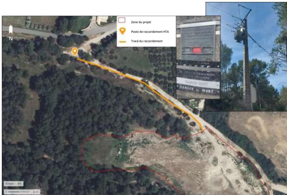
Figure 10 : Ligne HTA existante à 125m de l'entrée du site
