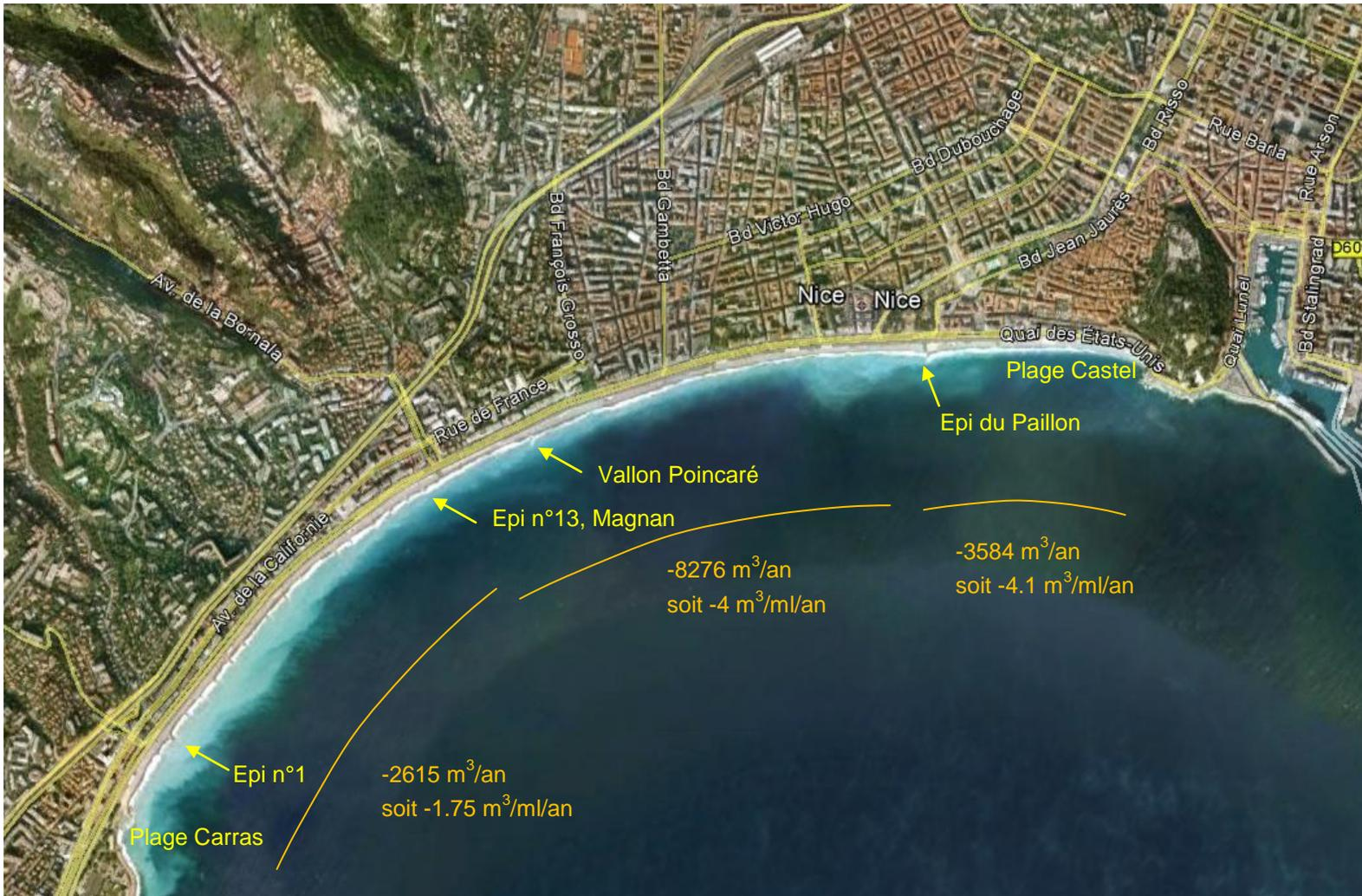
*Pertes de matériaux constatés par secteur de plage par différence entre les apports extérieurs et l'engraissement global observé*
