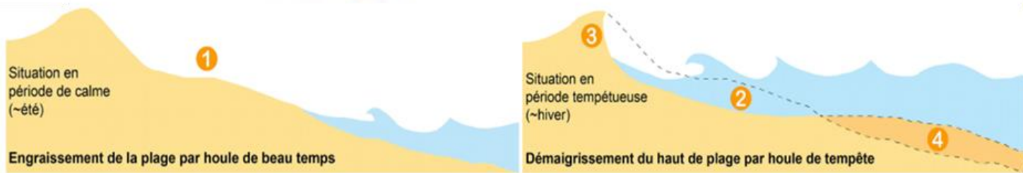
1 Berme. 2 Départ du sable du haut-estran, 3 et de l'avant-dune, 4 au profit du bas-estran où se forme une barre de déferlement immergée.
