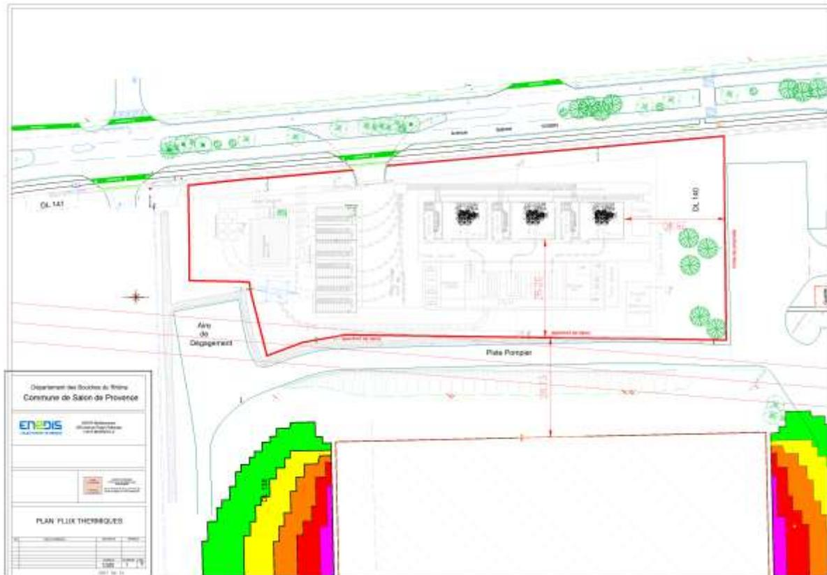
Les iso-contours vert représentent les flux thermiques au seuil des effets irréversibles (3 kW/m<sup>2</sup>).
